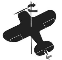
将自转轴向右旋转, 请注意方向舵的修正方向, 正确如上面箭头所示, 否则请参照陀螺仪调节图
