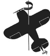
将自转轴向左旋转, 请注意方向舵的修正方向, 正确如上面箭头所示, 否则请参照陀螺仪调节图
