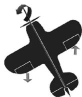
将横滚轴向左旋转, 请注意左右副翼的修正方向, 正确如上面箭头所示, 否则请参照陀螺仪调节图
