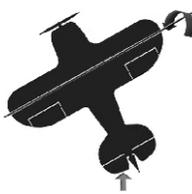
将俯仰轴向下旋转, 请注意升降舵的修正方向, 正确如上面箭头所示, 否则请参照陀螺仪调节图
