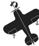
将横滚轴向右旋转, 请注意左右副翼的修正方向, 正确如上面箭头所示, 否则请参照陀螺仪调节图
