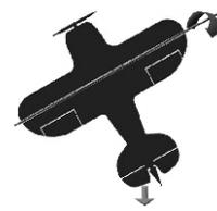
将俯仰轴向上旋转, 请注意升降舵的修正方向, 正确如上面箭头所示, 否则请参照陀螺仪调节图
