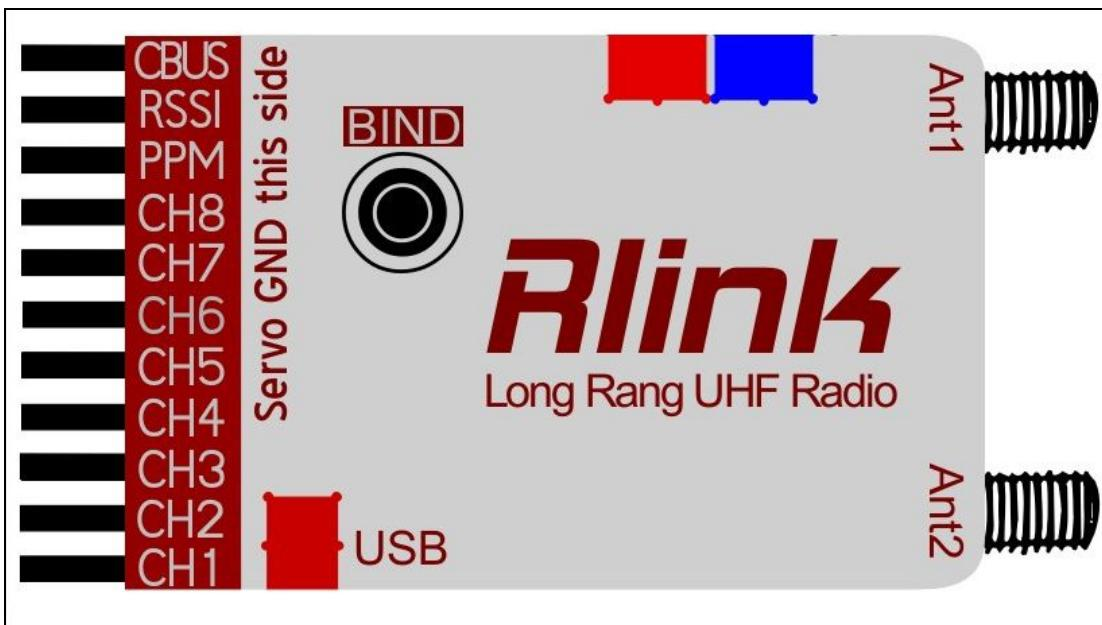
接收机和普通的 2.4G 接收机没有区别, 双天线为 SMA 接头, 建议 V 字形向上安装, 接收机天线请勿接触金属或者碳纤等导电物体, 当飞机上接入过多的舵机或者接入的舵机耗电较大, 请单独使用 UBEC 给接收机供电, 接收机天线请尽量远离视频发射机, 电调, 大电流线材, 有些升压开关电源模块和裸板的摄像头也会在 433 频段散射出较宽的频段干扰, 也需要尽量远离, 你可以选配带有延长线的接收机天线, 尽量减小一切机上的干扰。
