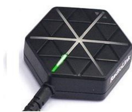
SE100 上电后靠近 天线端指示灯常亮
